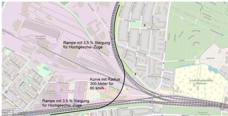
Diese Zeichnung zeigt, dass es möglich ist, die Verbindung kreuzungsfrei zu gestalten, wenn sie nur für Reisezüge ausgelegt wird.
